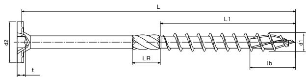
Lesni vijak "SPEED II" postavlja nova merila pri vgradnji v lesene konstrukcije. Zaradi zanesljive zareze torx, edinstvene konice S2 in posebne geometrije omogoča vijak hitro in učinkovito privijanje ter zmanjša možnost cepljenja lesa. Vijak je primeren za konstruktiven način obdelave lesenih materialov. Predhodno vrtanje in vijačenje ni potrebno.
