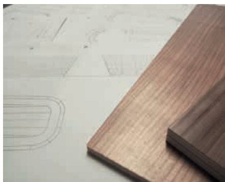
Posamezni elementi kadi se v plasteh zlepijo in tvorijo osnovno telo.
